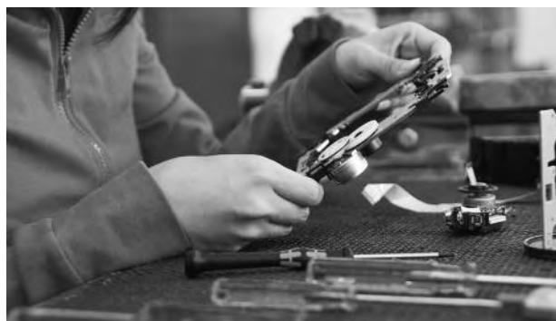
Computer werden zur fachgerechten Entsorgung und für das Recycling in Einzelteile zerlegt
